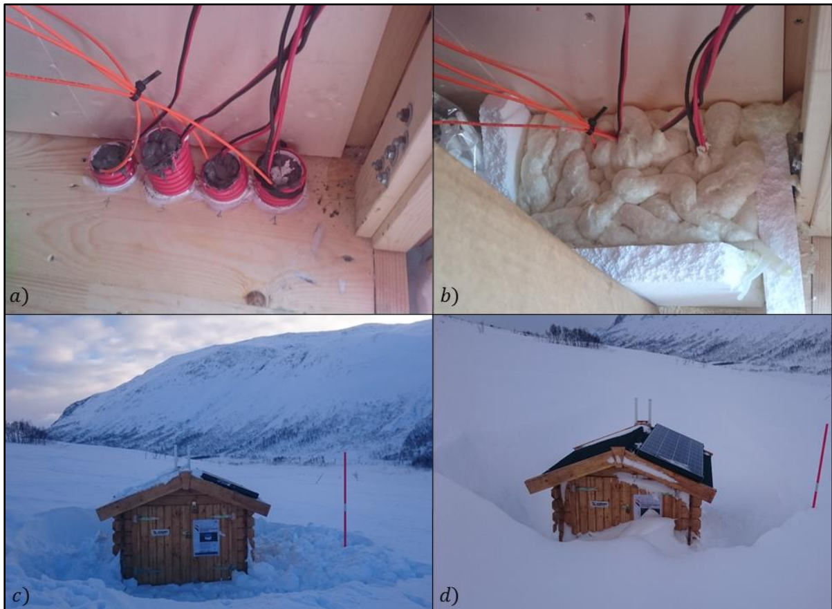
Figur 7-5: a) - c) Tiltak for å dempe støynivået på Kattfjordeidet. d) Tilstrekkelig snødybde over sentrumssensoren for å minimere støynivået. Foto: Martin Venås i SVV.
