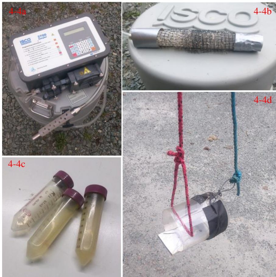
Figur 4-4: 4-4a) Automatisk prøvetaker, Isco 3700, 4-4b) Perforert sil, 4-4c) Beholdere til prøvene, 4-4d) Prøvetaker for kum
