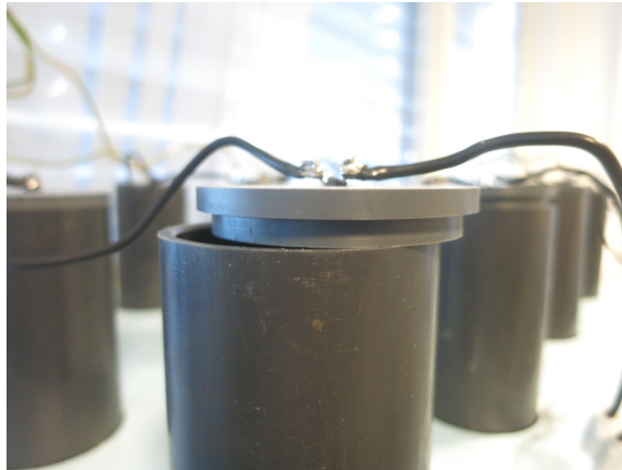
Figur. 9: Lokket på et forsøkskammer som ble dreid til for å passe godt i sylind- deren og tette for all ekstern lyspåvirkning.
