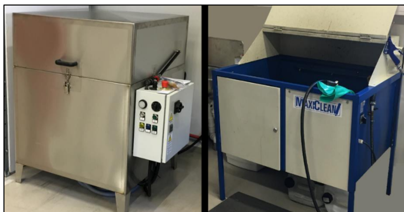
Figur 9.10 Til rengjøring benyttes en industrivaskemaskin (venstre) og en vaskekum (høyre).
