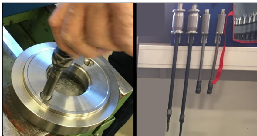
Figur 9.7 Endelokk festes til slagtrekkere (høyre) via overganger (venstre).
