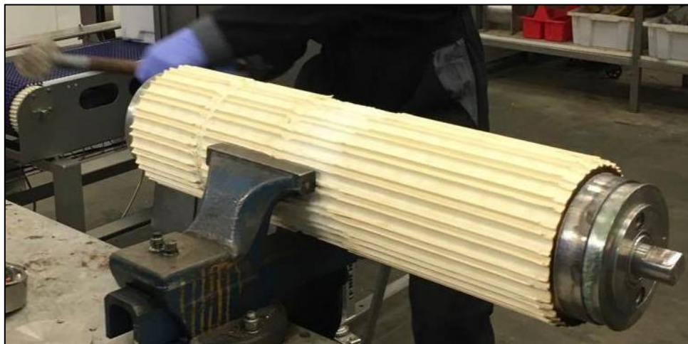
Figur 8.7 For å åpne trommelmotorer av typene 80i og 113i benyttes det per i dag en hammer.
