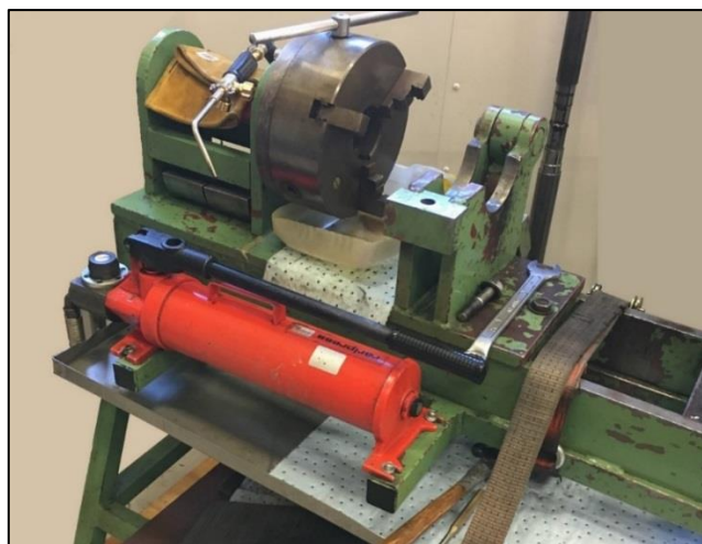
Figur 9.8 En bukk med justerbar innfestingsklemme benyttes til fastspenning av trommelrør.
