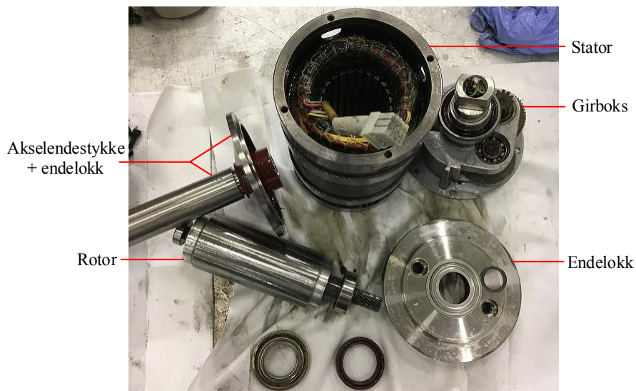
Figur 10.11 Nåværende prosedyrer tilsier at synlige oljerester skal fjernes før sluttmonteringen.
