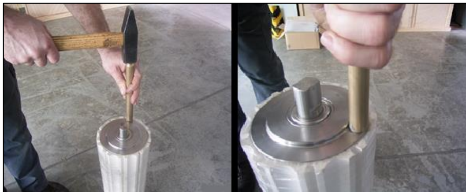
Figur 9.6 Interroll anbefaler bruk av stålhammer og messingdor for bryting av fastholdingsmasse.
