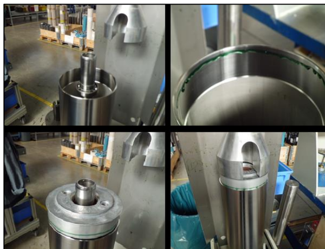
Figur 9.12 Interroll AS benytter en presse for lukking av trommelmotor. Foto: Interroll
