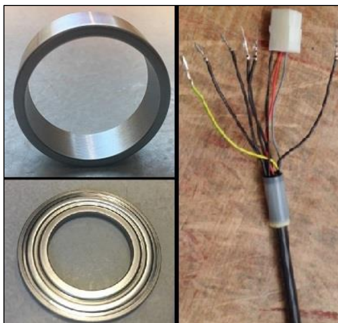
Figur 7.6 Venstre: Ground sleeve (øverst) og labyrinttetning (nederst).
