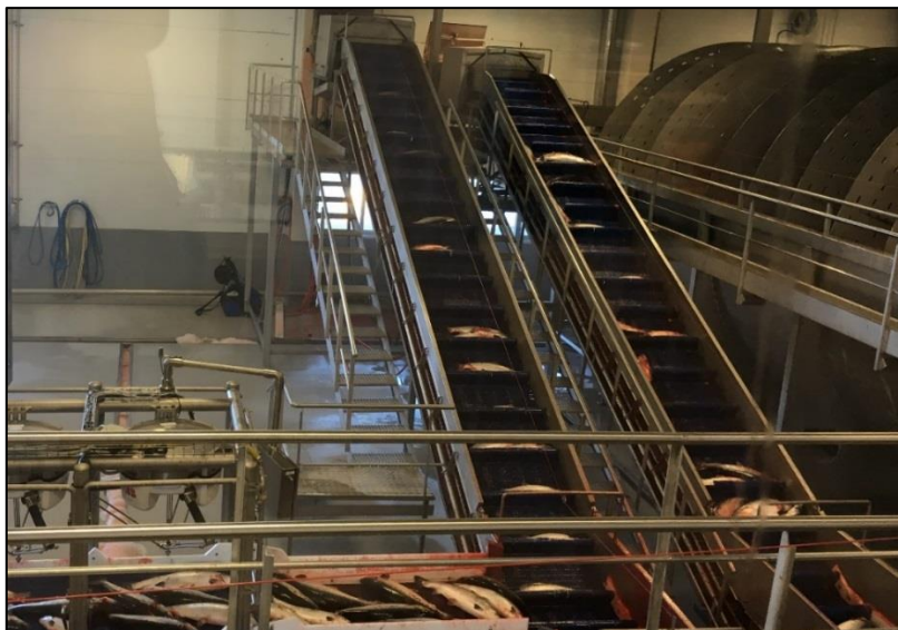
Figur 10.7 Laksen fraktes fra bløtting til avkjølingstanker via to parallelle stigebånd.
