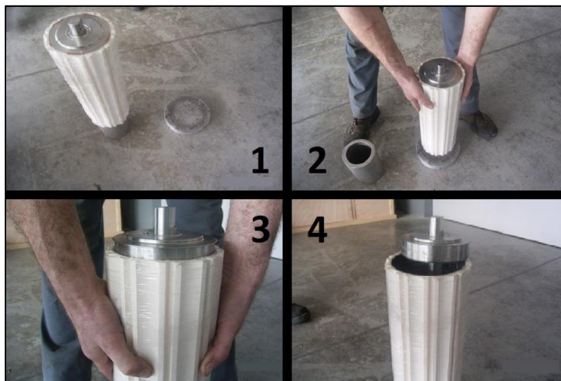
Figur 9.9 Interroll anbefaler bruk av aluminiumsplate for åpning dersom slagtrekkere ikke er tilstrekkelig. Foto: Interroll
