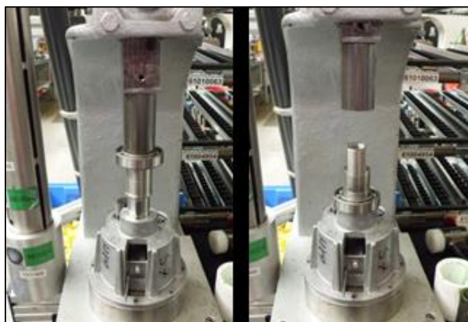
Figur 9.11 Interroll AS disponerer en presse for påføring av kulelager. Foto: Interroll
