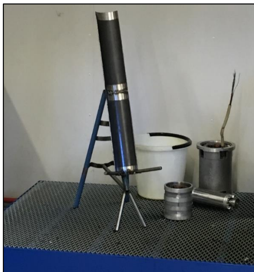
Figur 9.5 Interroll AS disponerer en egenprodusert bukk for å tømme trommelrøret for olje.
