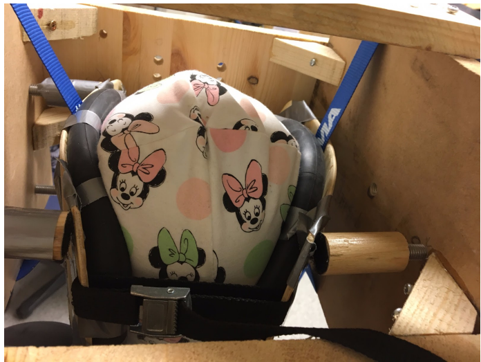
Figur 43 Prototype under testing. Sideplater bøyes mye ved hjelp av reimer
