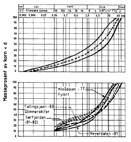
Figur 9 Kornfordelingskurver fra norske TBM-tunneler (Statkraft/NGI)
