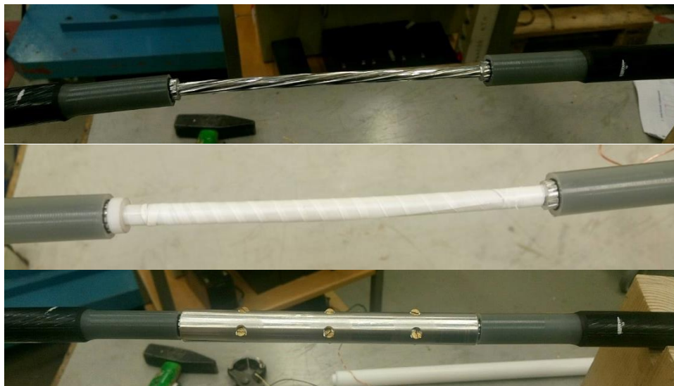
Figur 20: Montering av hylse. Øverste bildet viser avstand mellom de ulike delene under reduksjon av ledertverrsnitt. Denne figuren er tatt fra en tidligere masteroppgave og gjengitt her siden dataene er de samme. Neste bilde viser lederen med redusert tverrsnitt. Så blir teflon lagt på før hylsen blir skrudd fast.
