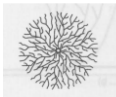
Figur 11: Bildet viser hvordan mønstrene til overflateutladninger danner seg. Mønstrene baserer seg på Lichtenberg-figurer [19].
