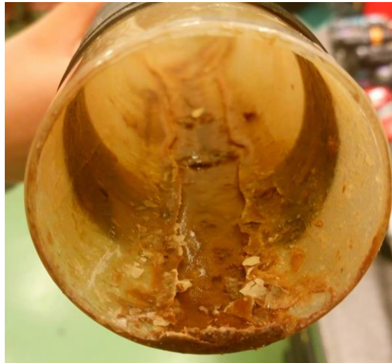
Figur 45: Bildet viser karet etter end forsøk. Det observeres lim som har blitt presset ut av skjøten.
