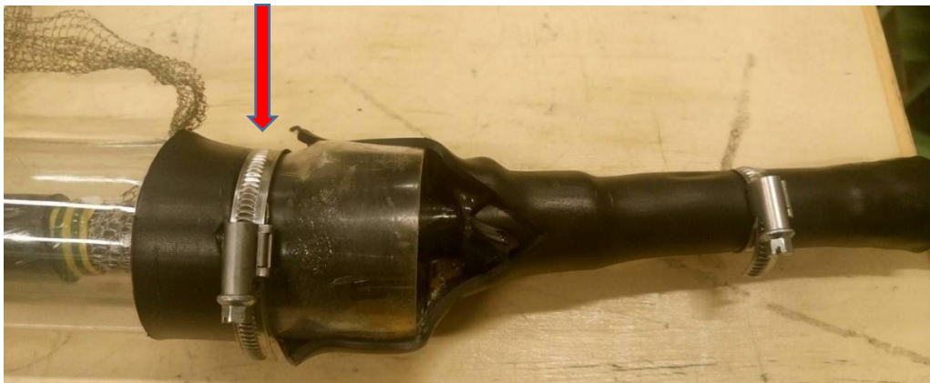
Figur 18: Bildet viser krympestrømpe som har sprukket opp under forsøk på å gjøre karet vanntett.
