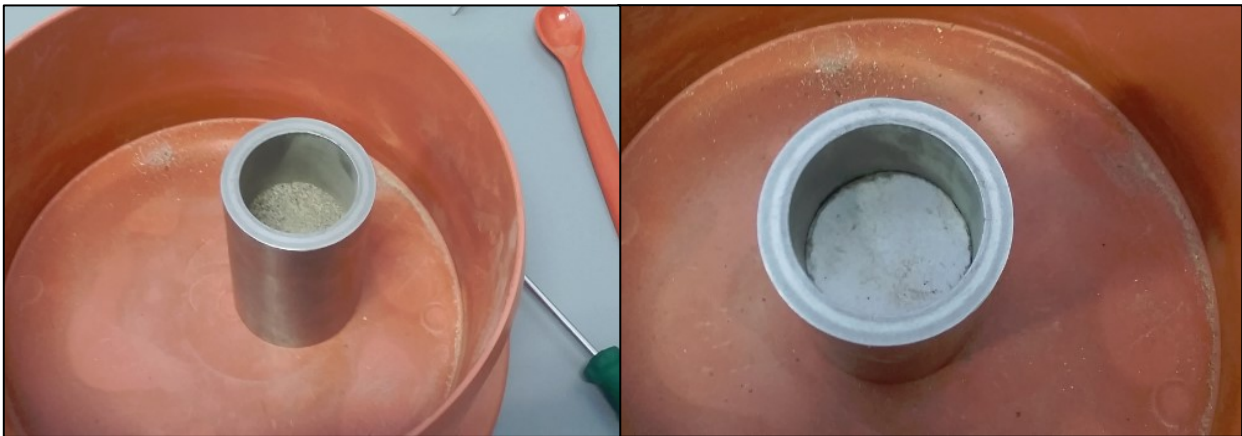
Figur 3.8: Klargjøring av prøvematerialet til porøsitetmåling. Bilde til venstre viser papirfilteret som ble brukt for å hindre partikler i å trekke inn i måleapparatet. Foto: Håvard Tømmerdal.
