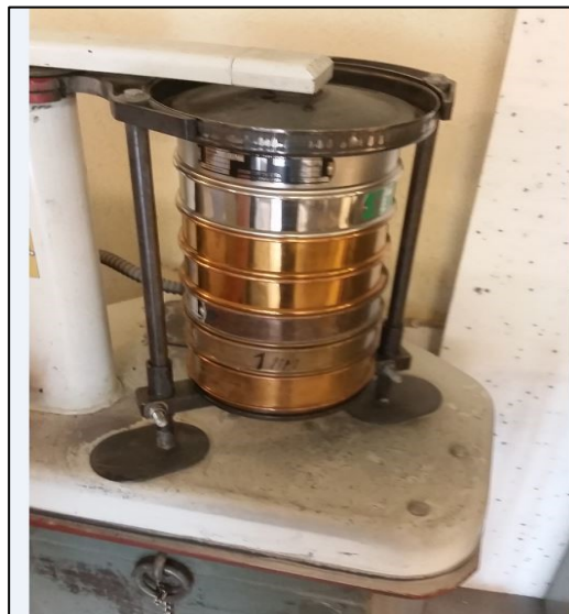
Figur 3.6: Siktemaskin som ble benyttet i sikteanalysen. Foto: Håvard Tømmerdal.
