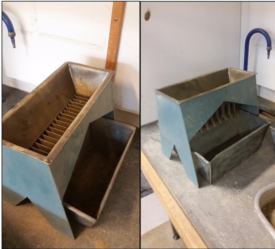
Figur 3.5: Apparat brukt til splitting av prøver. Foto: Håvard Tømmerdal.
