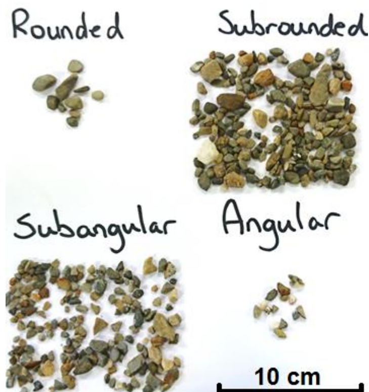
Figur 5.6.3: Klassifisering av korn etter rundingsgrad. Foto: Benjamin Trøan (11. mai 2017).
