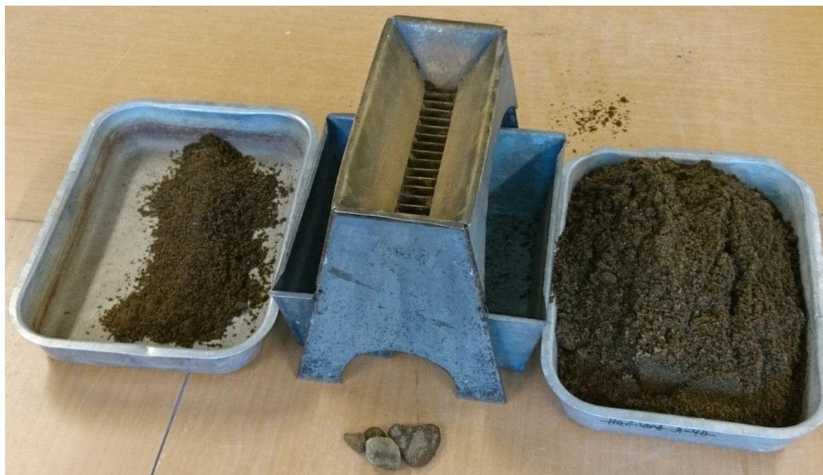
Figur 3.5.1: Splitter til bruk for å dele inn prøvematerialet på en slik måte at innflytelsen av gravitasjon utelukkes. Foto: Benjamin Trøan (8. mai, 2017).
