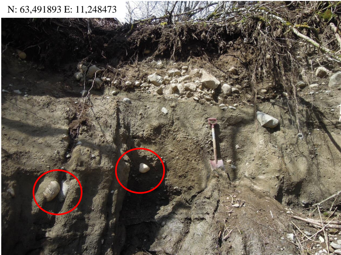
Figur 4.5.3: Snitt gjennom de øvre 4-5 meter av løsmassene i bruddkanten. Det øvre laget inneholder grovere materiale. Legg merke til steiner (røde sirkler) også i de finere lagene. Bildet er tatt mot nord. Foto: Benjamin Trøan (3. mai 2017).
