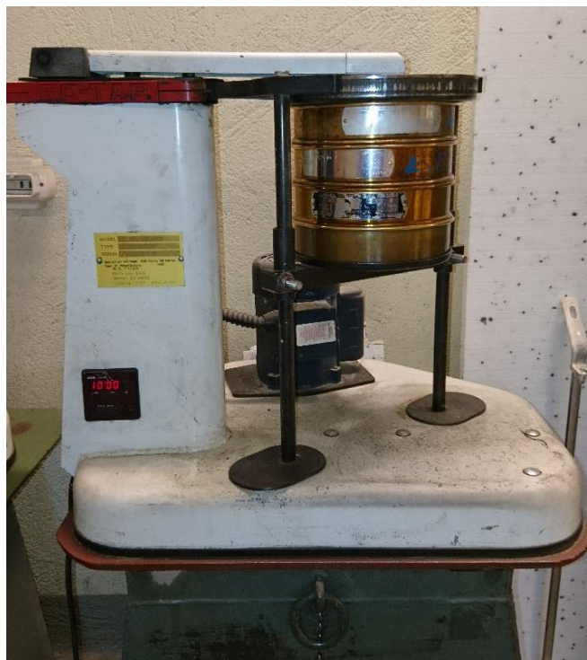
Figur 3.5.2: Siktemaskin brukt til kornfordelingsanalyse. Foto: Gunnar Vistnes (11. mai 2017).
