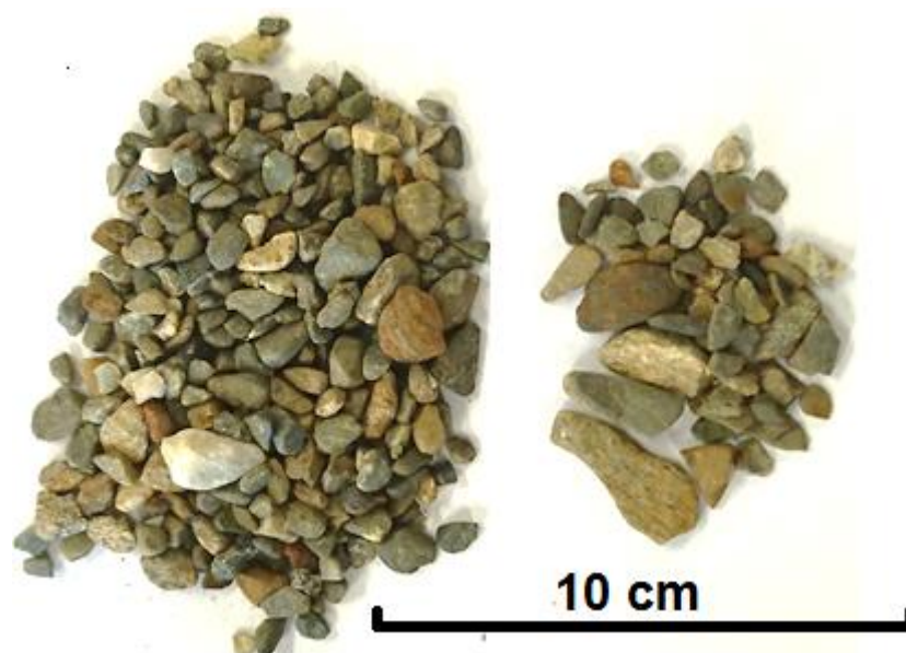
Figur 5.6.2: Kubisk materiale til venstre. Ikke-kubisk materiale til høyre. Foto: Benjamin Trøan (11. mai 2017).
