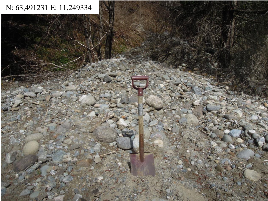
Figur 4.5.2: Flomskredmassene i foten av skredet. Bildet viser rundingsgraden og de relative kornstørrelsene. Bildet er tatt mot nord. Mot sør er massene finere, ned mot sand-silt størrelse. Foto: Benjamin Trøan (3. mai 2017).
