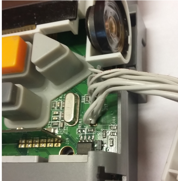
Figur 7.5: Ledninger loddet til punktene
