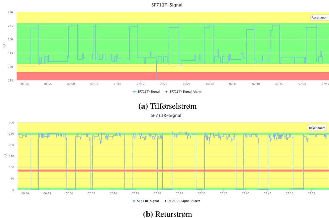
Figur 4.2: Roadmasters visning av sporfelt med forstyrrelser i både tilførsel og retur
