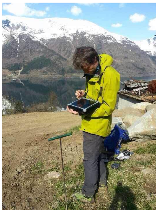
Figur 4.3 Toughbook med ArcGIS til bruk for direkte registreringar av observasjonar i felt, her ved Knut Stalsberg v/NGU. Stikkstang blir brukt som supplerande verktøy til overflateobservasjonar (Foto: Lena Rubensdotter, 27.04.16).
