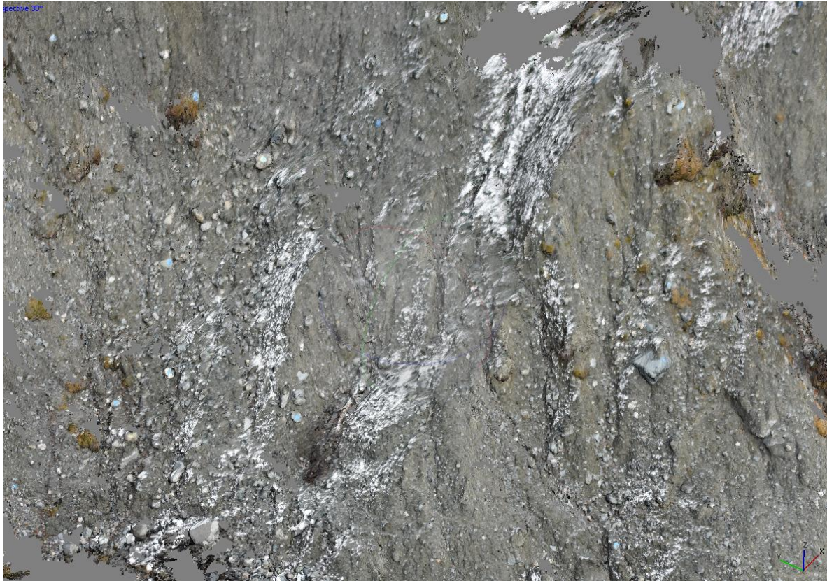
Figur 21: Skjermdump av høytetthetspunkttskyen fra november. Med dette detaljnivået kan man identifisere individuelle steiner, strukturer og kontrollpunktene.
