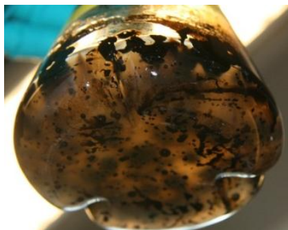
Figur 39: Prøve 4, ML - dag 7 Kolben inneholder inokulum, 50 % løsemiddel og olje, og viser at oljen har klumpet seg i vannfasen
