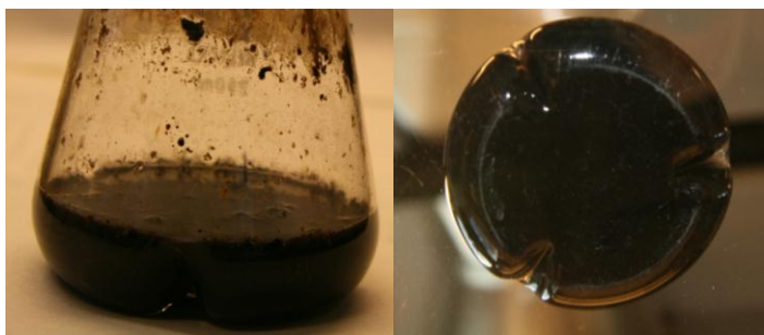
Figur 24: Prøve 5 L004, 50 % løsemiddel, dag 7 - Kolben inneholder mineralmedium MMacYE, inokulum, 50 % løsemiddel og olje. Bildet viser at oljen er emulgert i vannfasen .
