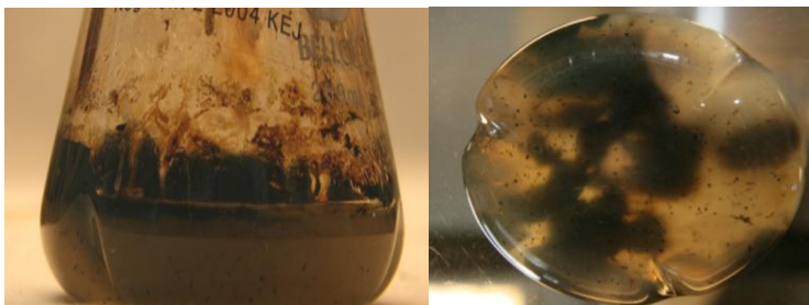
Figur 20: Prøve 1 L004, dag 7 - Kolben inneholder mineralmedium MMAcYE, inokulum og olje, og viser at oljen har samlet seg som klumper i vannfasen.
