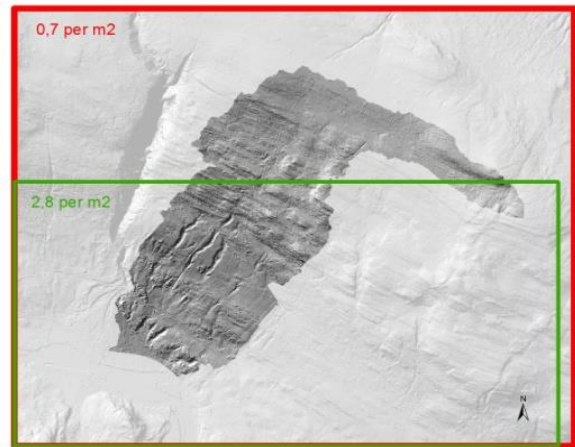
Figur 14: Gjennomsnittlig terrengpunktetthet fra LiDAR-skanningen for pilotområde Brandrudsåa
