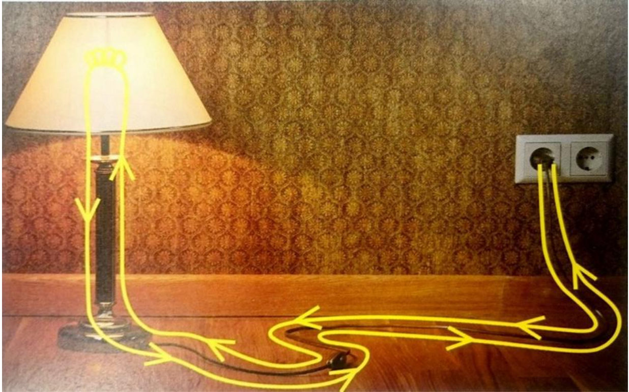
Figur 38 Påtegnet fotografi for å vise at strømmen går i ring, Nova 10 av Steineger & Wahl
