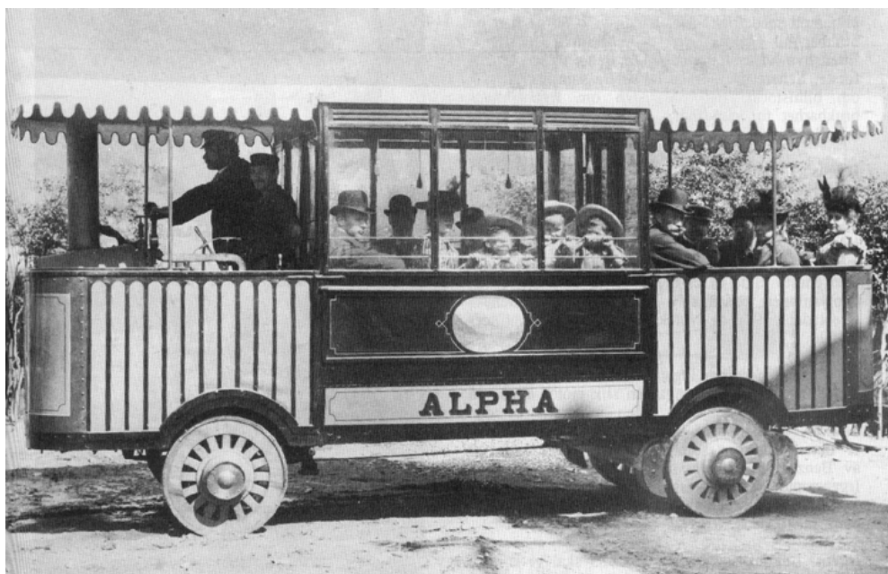
Dampvognen «Alpha» som ble prøvekjørt i Bergen i 1899 og i Trondhjem i 1900. I Trondhjem strandet forsøkene på grunn av tekniske vanskeligheter når det gjaldt dampvognens konstruksjon. (Foto i egen samling).
