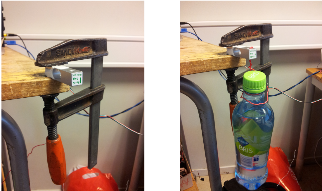
Figur 24: Oppsett for test av lastcelle
