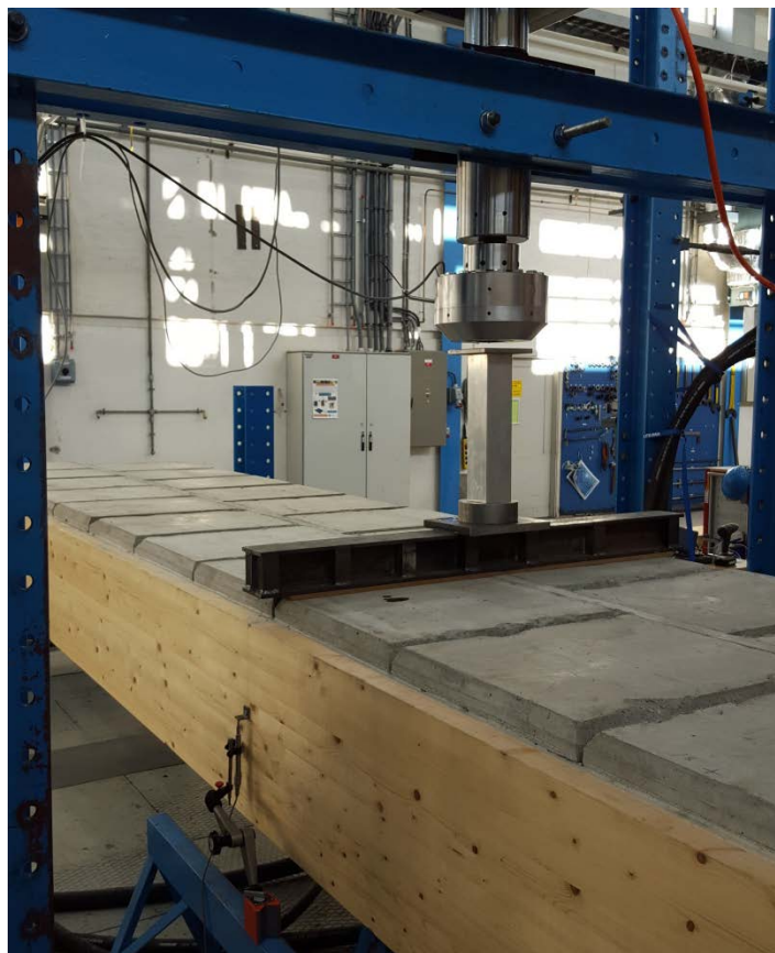
Figur A.2.1 Lastsituasjon 1, utført 26.2.2016 uten fuger.
