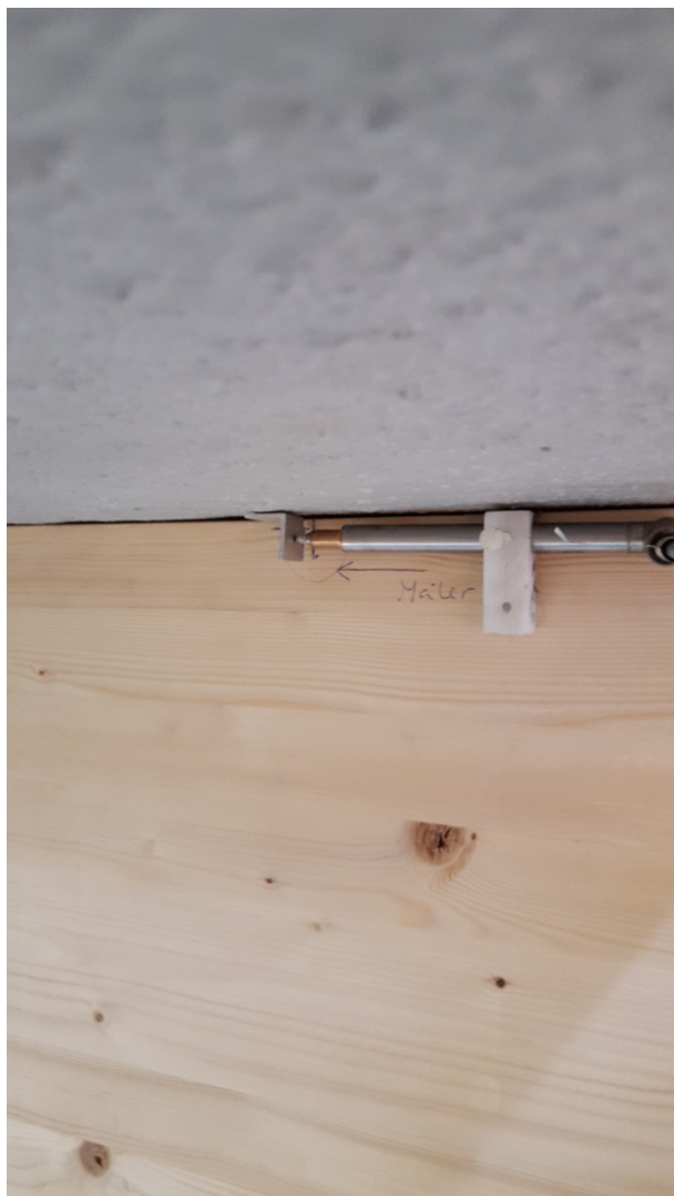
Figur A.3.3 Avstandsmålløp i ev den relativ forskyvning mellom betongen og limtrebjelken.
