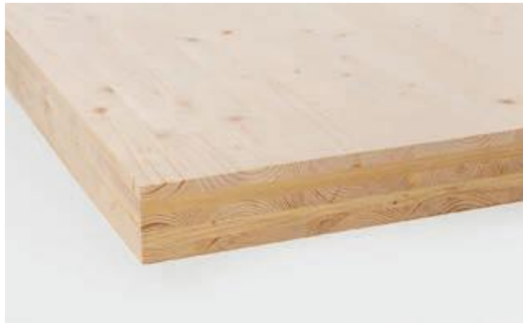
Figur 4.1 Oppbygning av massivtre (HASSLACHER NORICA TIMBER, 2016).
