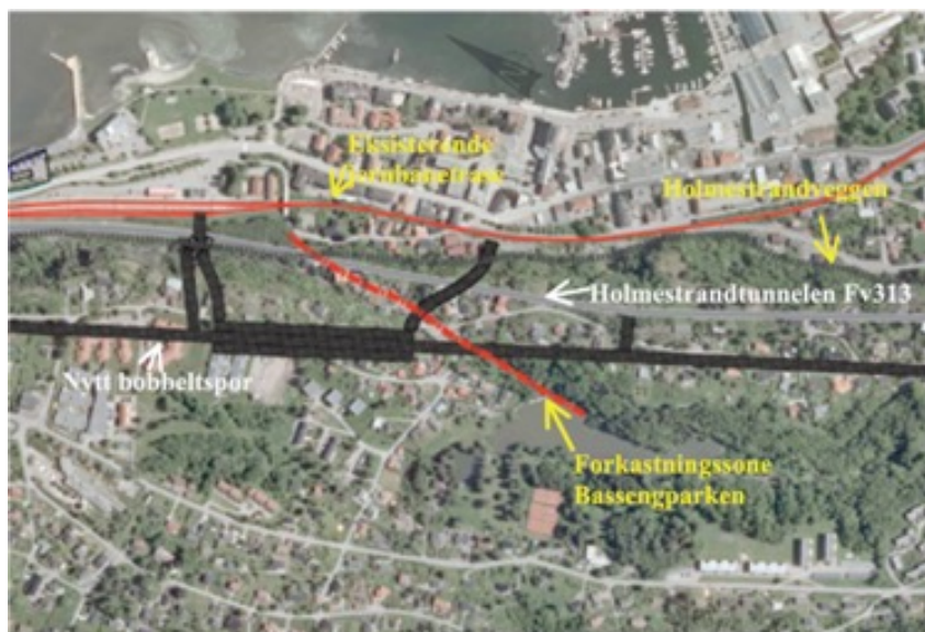
Figur 4.11: Forkastningssone ved bassengparken fungerer som en hydrogeologisk barriere (Langford, Kveldsvik og Sagen 2011)
