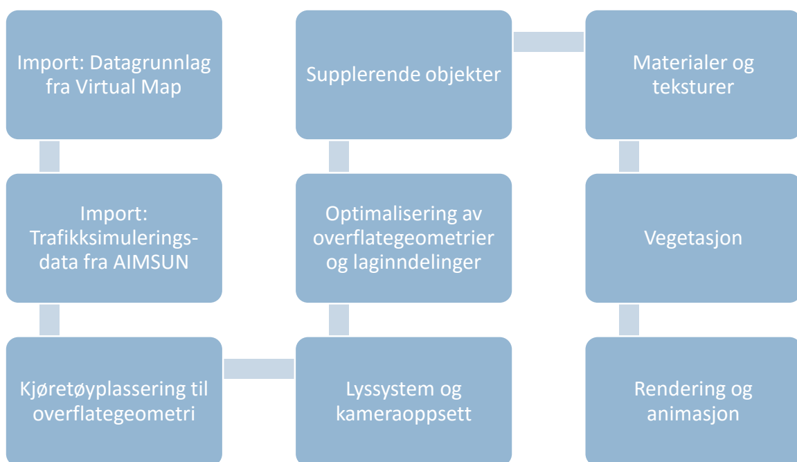
Figur 26 - Fremgangsmåte for 3D-visualisering i 3ds Max
