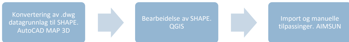
Figur 10 - Fra .dwg til trafikksimuleringsnettverk i AIMSUN
