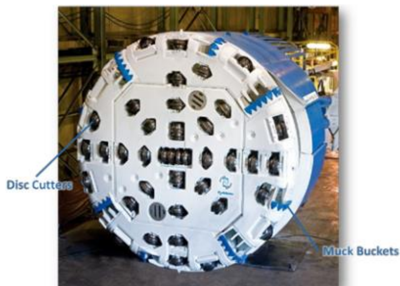
Figur 4 - Kutterhode på TBM som viser diskcuttere som bryter berget, og skoper som transporterer berget gjennom kutterhodet og ut til transportbånd (The Robinson Company, 2015).
