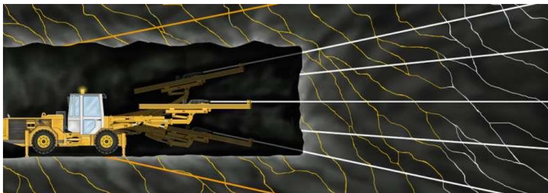
Figur 12 - Sonderboring og injeksjon (Solerød, 2012).
