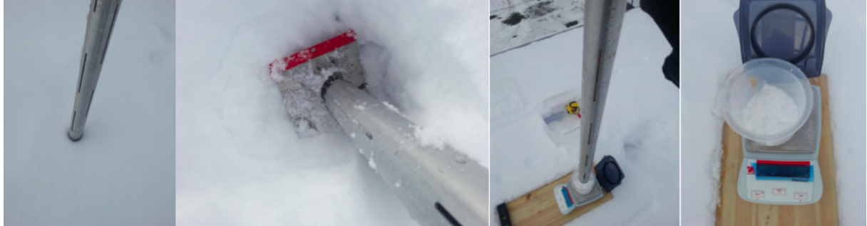
Figur 15: Snøprosedyren: Ta prøve, mål høyden (cm) og vei prøven (g).
