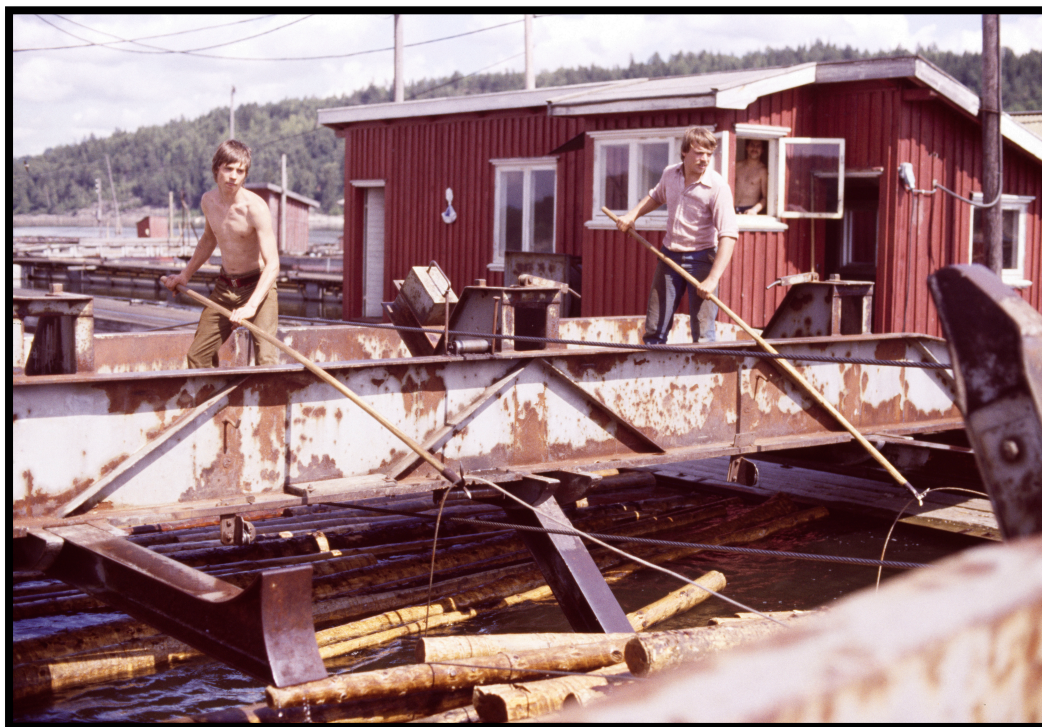
Bilde: To gutter i arbeid på en mosemaskin på Glenнетangen. De bruker fløterhaken for å lettere få vaieren rundt mosene. Bygget bak er maskinhuset, hvor vi ser en mann som styrer mosemaskinen. (Foto: Hans Hamid Rasmussen)
