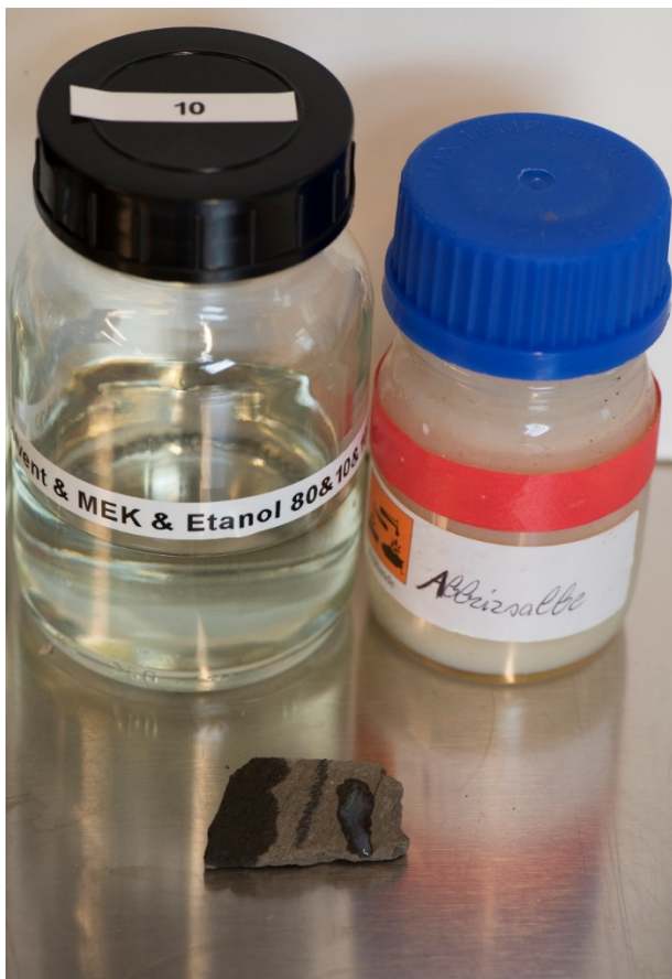
Figur 6 Forsøk med løsemiddel nr. 10 og Abbeizsalbe på stein fra lokaliteten i Hell etter en time
