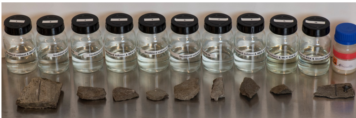
Figur 3 Forsøk med løsemiddel på stein fra lokaliteten i Bardal etter en time
