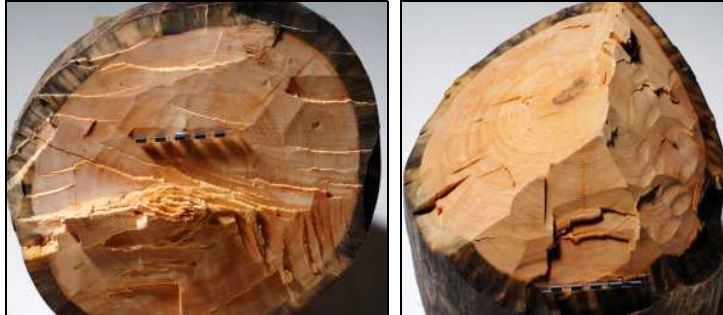
Figur 104. Endeflater fra ferdige skåret stokk, bildet til venstre viser det plane, loddrette skjæret, til høyre ser vi det skrådde, vinklede skjæret fra den delen av stokken som brekker av. Vi kan se tre skjærflater, ett resultat av følgene prosedyre; tømmeren skifter side og skærer fra to sider, stokken roteres en gang, og tømmeren fortsetter å skære en tredje gang før stokken brekker over. Dermed brukes øksa aktivt på tre forskjellige skjær i skåret.
