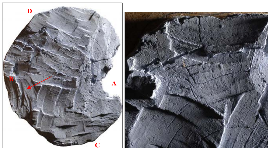
Figur 107. Verktøyspor i område B 4.1-B 4.8, rød pil i bildet til venstre viser huggeretning og område med verktøyspor. Legg merke til signaturene i tømmeret er som signaturene i område A.
