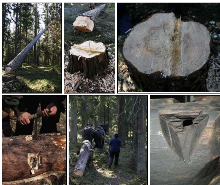
Figur 102. Felling og øying for frakt av tømmer etter tradisjonskunnskapens prinsipper, etter Roald Renmælmo. Nederst til høyre foto av øye fra 1000-tallet (se figur 98), se tradisjonell måte å ”øye” på nederst til venstre, metoden har holdt seg lenge.
