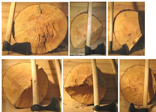
Figur 92. De seks rekonstruerte øksene benyttet under forsøk 2.
