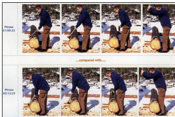
Figur 144. De to analyserte huggeprosessene med å endekappe tømmer. Første rekke er ved 01:00:23, tidlig i prosessen. Andre rekke viser tømmerrens typiske kroppsbevegelser et stykke senere i huggeprosessen.
