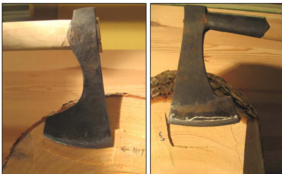
Figur 33. Bilde til venstre viser en skjeggøks med god avrundning bak mot grevet/bakhynna – mens bildet til høyre viser en skjeggøks med mindre avrundning i lengderetningen av øksekeften (mindre eggkurvatur).
