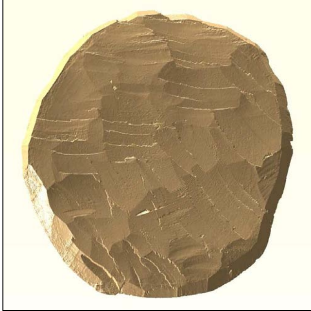
Figur 31. 3D-fotoskannet endeflate som er "kollet" (etter tradisjonen). Å kolle vil si å skråskjære ytterkanten av tømmeret. Skråskjæringens funksjon er å forhindre oppflising under frakt (skråskjæringen kan sees nederst til høyre på stokken).
