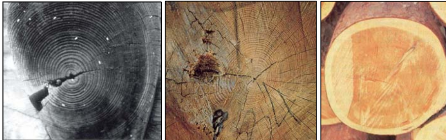
Figur 42. Til venstre ser vi tømmer som har vokst relativt hurtig, de harde årringene (gårene) står igjen når den mykere vårveden slites bort. Sommerveden er omtrent like brede som vårveden. Neste stokk har brun alved og brede gårer. Tredje stokk fra venstre er lys og gulaktig. Dette tømmeret har liten andel med sommerved (gåre) og er ypperlig til mange formål. Etter Godal 1996.
