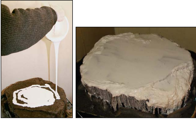
Figur 10; silikonavstøpningen fordeles utover endeflaten og herder, fotografert av Harald B. Høgseth, PBM, HIST.
