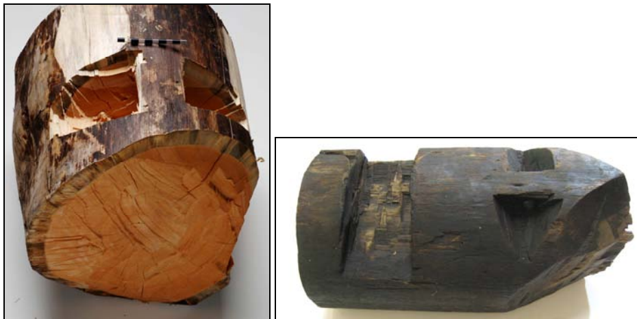
Figur 30. Til venstre tømmer med ”øye” for frakt etter den handlingsbårne tradisjonen, Til høyre tilsvarende ”øye” fra 1000-tallet, Tømmerlevning med ukjent nummer og funnkontekst ved Vitenskapsmuseet, NTNU, Trondheim.
