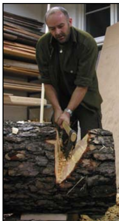
Figur 103. Undertegnede skårer. Det plane, loddrette skjæret sees til venstre mens det skråde, vinklede skjæret kan sees til høyre.
