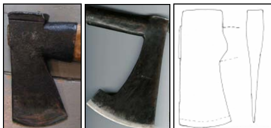
Figur 86. Illustrasjoner av tre av de fem øksene benyttet under forsøk 1, til venstre en boløks, i midten en skjeggøks, til høyre en fellarøks (mustadøks) fra nyere tid.
