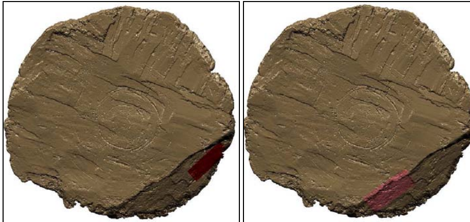
Figur 97. Øying av tømmer med smaløks etter tradisjonell måte. Fra egne undersøkelser.
