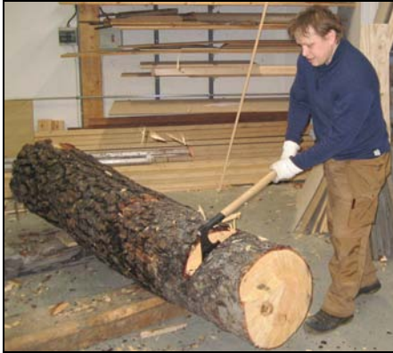
Figur 27. Skåring av tømmer.
