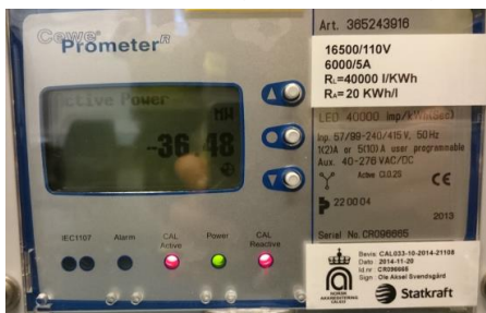
FIGUR 6-6: Effektmåler benyttet for avlesning av effekt.
