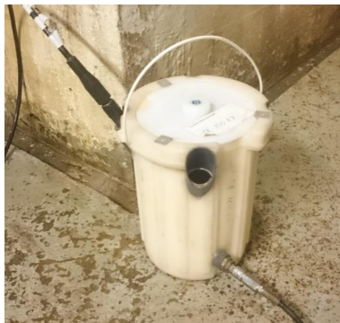
FIGUR 6-4 – Isolert tank for måling av spaltevannstemperatur.
