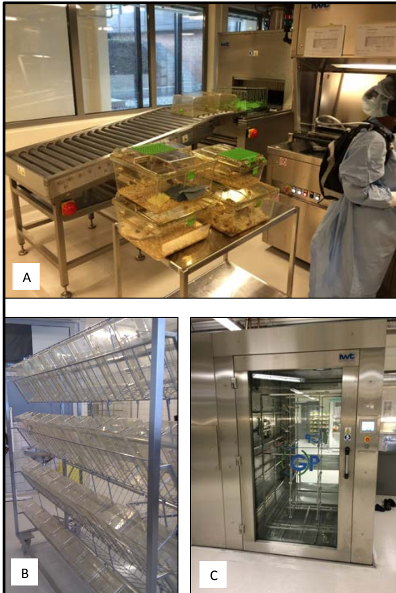
Figur 3. Vasking av bur. Skitne bur legges på transportbånd og vaskes i tunnel-vaskemaskin (A) eller stables opp ned i stativ før de kjøres inn i vaskemaskinen (B). Rack-vaskemaskin til vask av rack, burlokk o.a. (C). Alt rengjort utstyr tas ut på ren side av vaskeriet.
