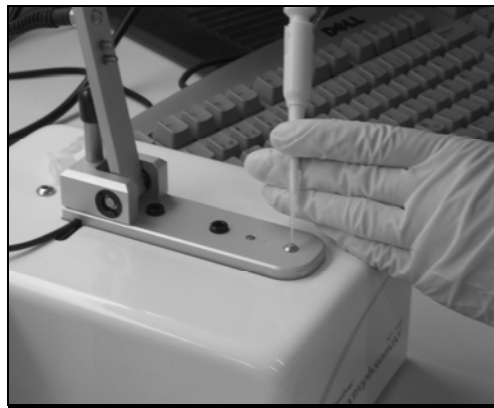
Figur 17 Forsiktig legges en liten dråpe av prøven på spektrofotometeret.
