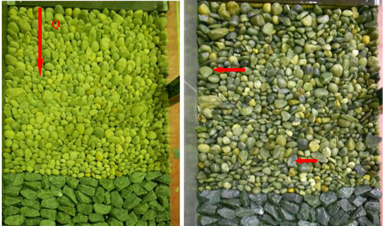
Plastring før og etter forsøk
