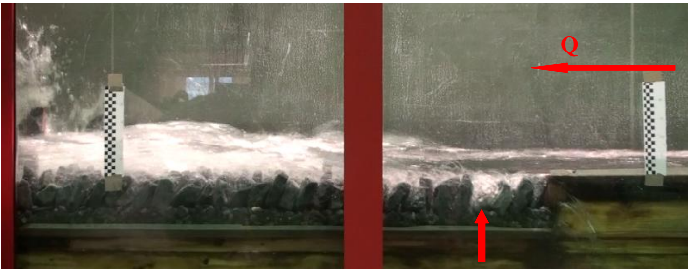
Figur 4-1 Forsøk grå, store ved brudd v_{krit} = 4,56 \text{ m/s}
