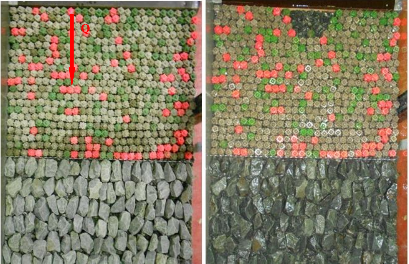
Plastring før og etter brudd
