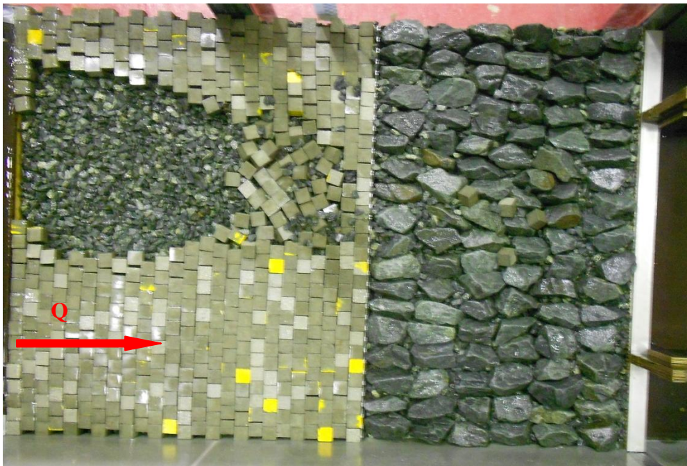
Figur 4-5 Plastring etter brudd, v_{krit} = 2,0 m/s
