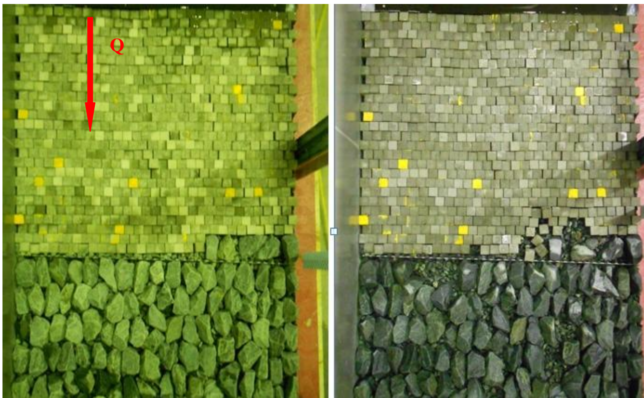
Plastring før og etter brudd
