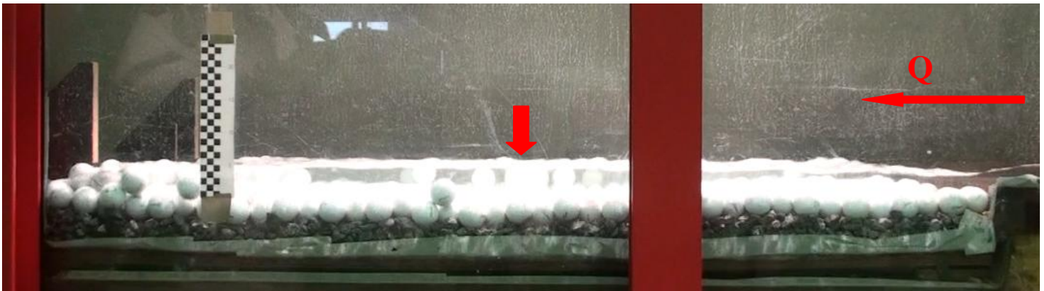
Figur 4-4 Plastring etter brudd v_{krit}=0,46 m/s
