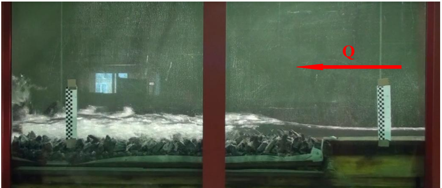
Figur 3-3 Eksempel på forsøk. Grå, små Q=151,7 l/s ved brudd
