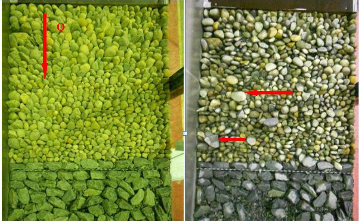
Plastring før og etter forsøk
