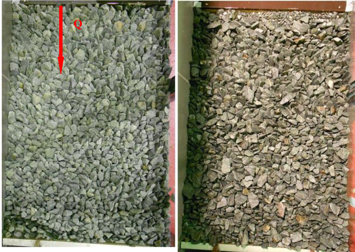
Plastring før og etter forsøk
