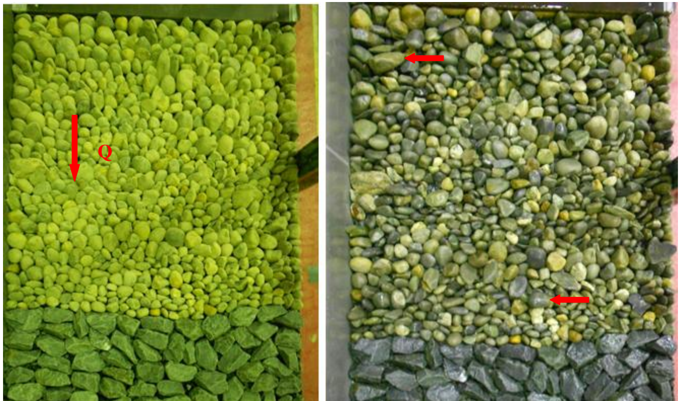
Figur 4-3 Plastring før forsøk (tv.) og etter (t.h) brudd, v_{krit} = 2,9 m/s
