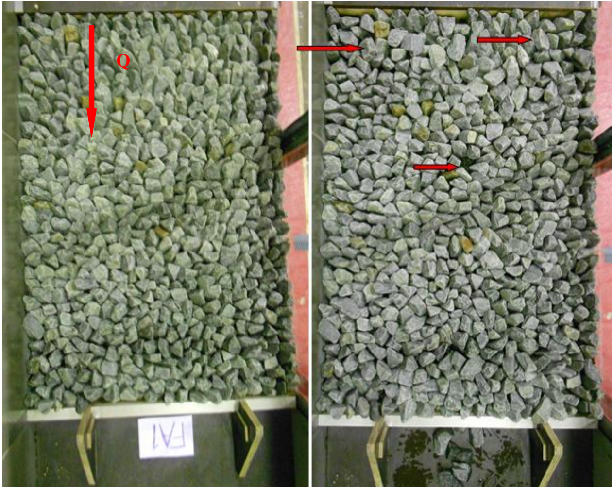
Plastring før og etter forsøk
