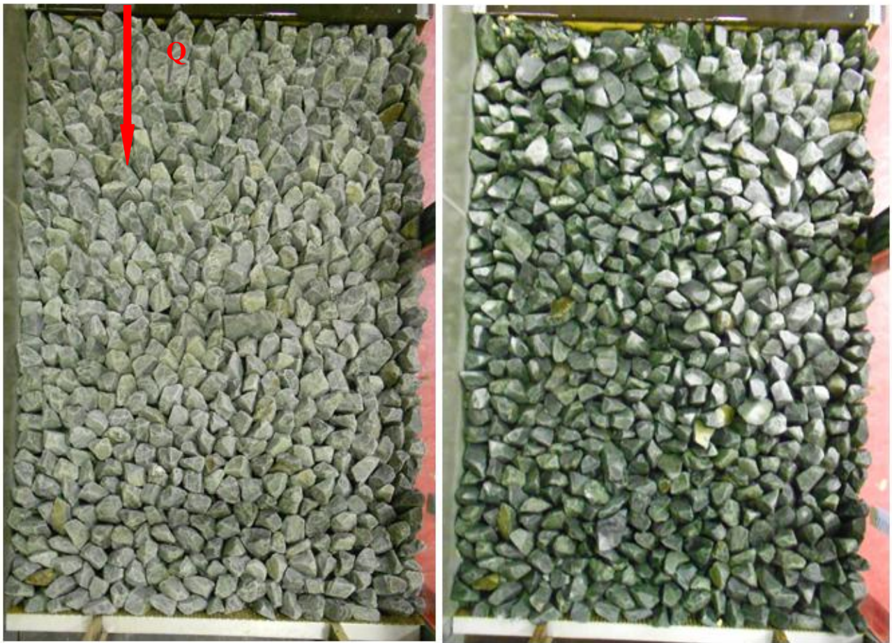
Plastring før og etter forsøk
