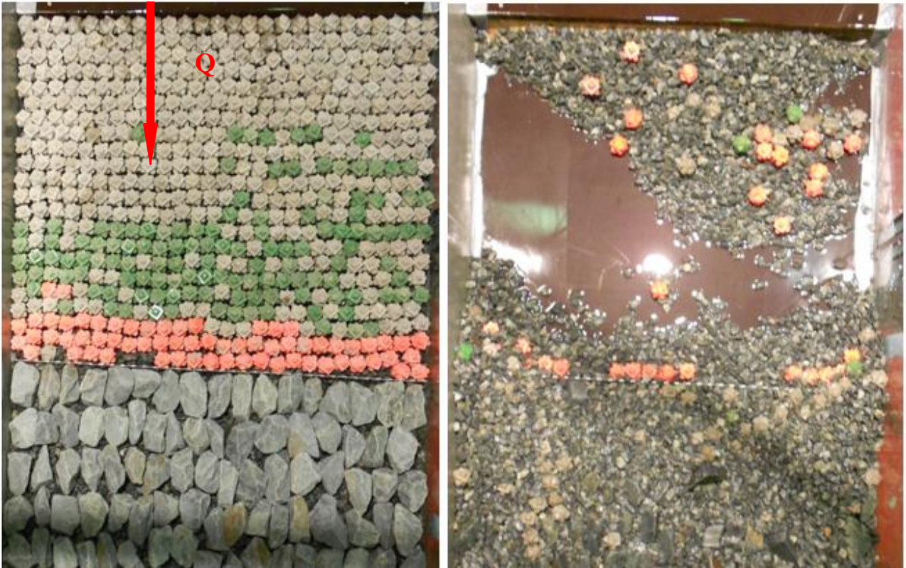
Plastring før og etter forsøk
