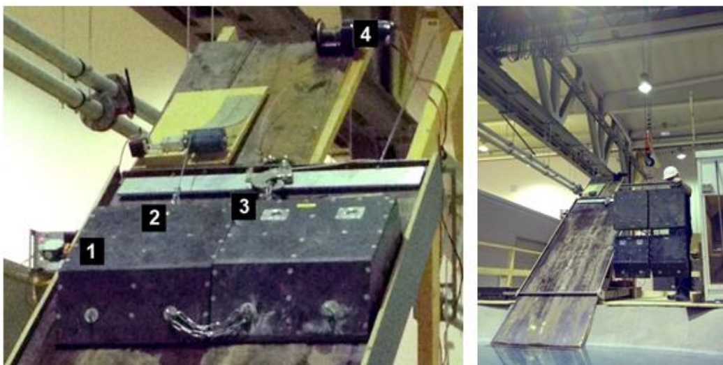
Figur 3.7 – Oversikt over skredets komponenter: 1-Lyssensor, 2-Hastighetsmåler, 3-Utløsningskrok, 4-Elektrisk vinsj. Figuren illustrerer at skredet heises opp på skredrampen ved hjelp av en kran.
