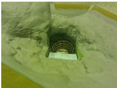
Figur 6.9 Opphavleg utforming av samlekanal og innløp sjakt
