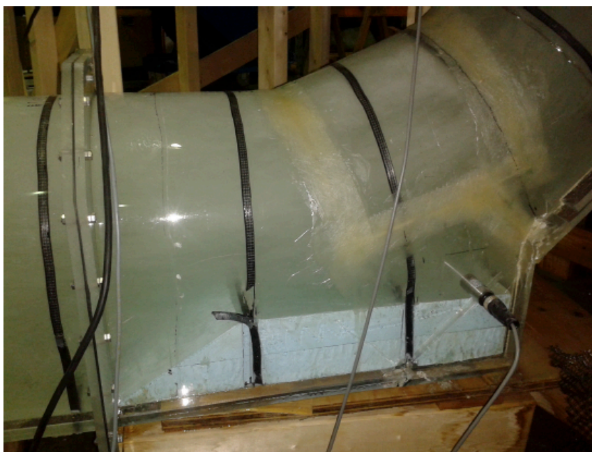
Figur 6.6 Innsnevring i byrjing av flomtunnel (Roe, 2013)
