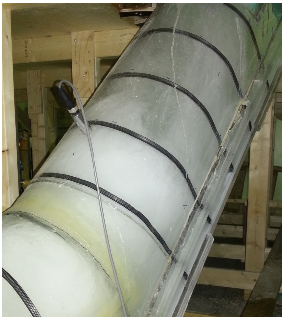
Figur 3.1 Uryddig strøymingssituasjon i sjakta ved Q_{DIM} i modellen av flomløp Vasslivatn
