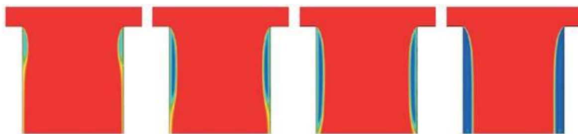
Figur 3. Kavitasjon og hydraulisk flipp i dyse (Tafreshi & Pourdeyhimi, 2004)
