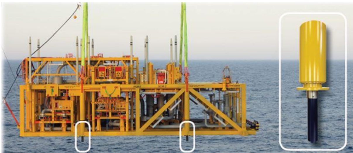
Figur 2. Soft Landing Cylinder montert på subseamodul. Bilde fra: EAB Engineering.
