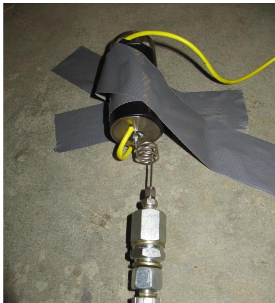
Figur 14 Trykkcellen ble teipet fast til gulvet under målingene for å unngå forstyrrelser
