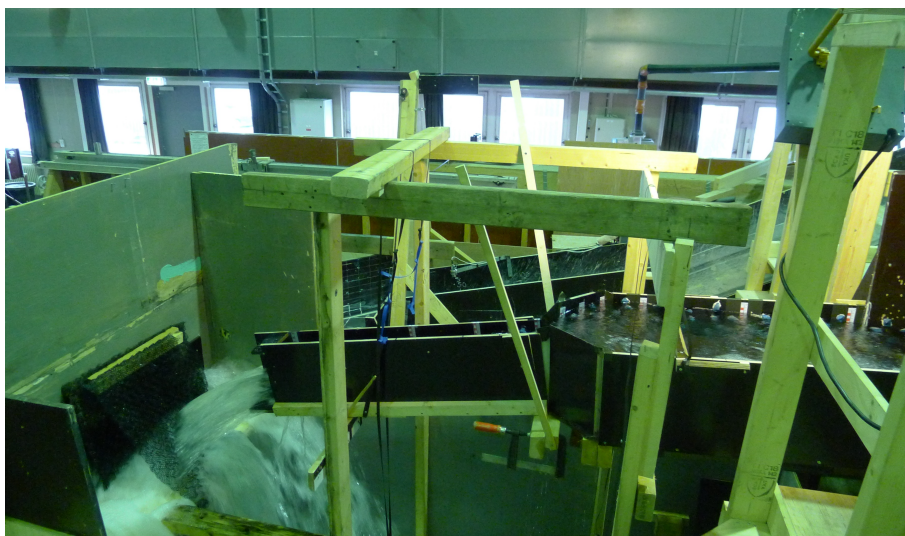
Figur 3.4: Bilete av modulbasert avløpssystem, frå forsøk 1-10-45-0-1-0, med vassføring 45 l/s. Biletet ser ein, frå høgre mot venstre, enden av kanalveggen i sidekanalen, kanalutviding, samlevinkel (45°) og avløpskanal (10°).
