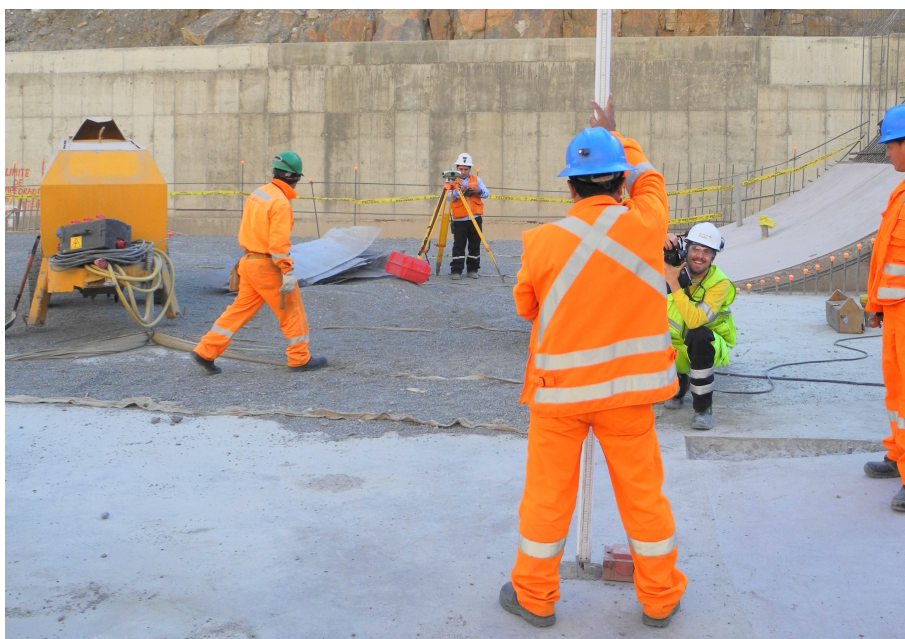
Figur 38: Måling av setninger foran overløpet til Checras, den 8. august 2012.
