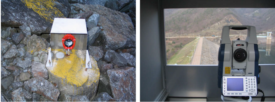
Figur 6: Robotisk totalstasjon med mottakerprisme [19].
