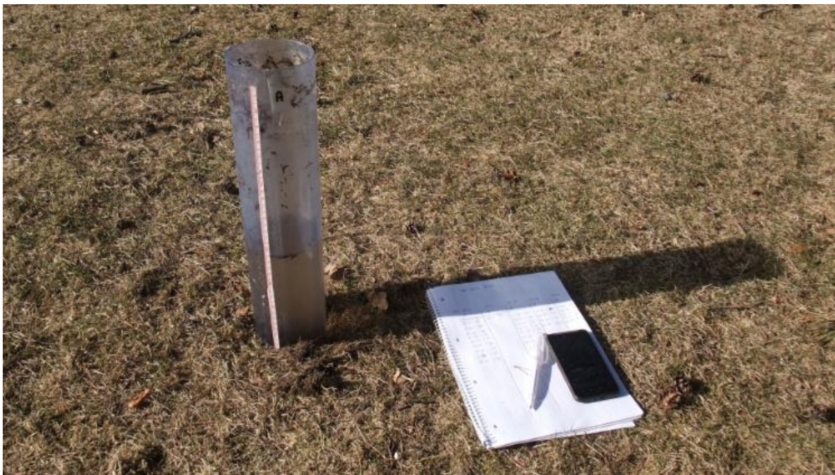
Figur 24: MPD infiltrrometer fra måling i Sandnes. Notatblokk og stoppeklokke er på plass (Foto: T. A. Lende).
