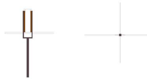
VERTIKALT - INNFESTE STÅLSTAG 1:10
