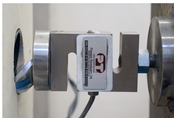
Figur 5.7: Digital S-type lastcelle med påmontert sfærisk lager på venstre side
