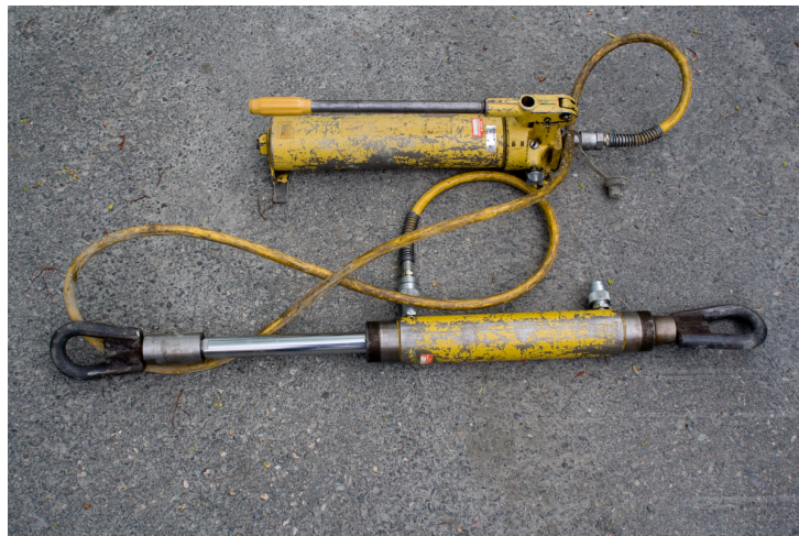
Figur 7.3: Jekk 16 tonn tilkoblet håndpumpe
