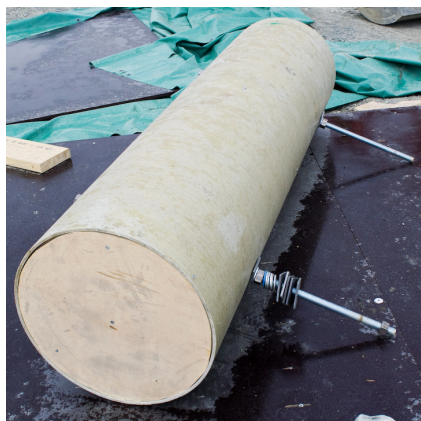
Figur 7.16: Foto av forsterket rør for oppløftsforsøk
