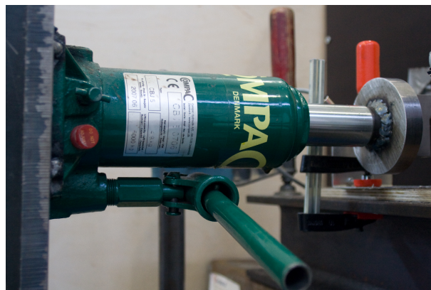
Figur 5.6: Jekk for å påføre aksielle trykkrefter
