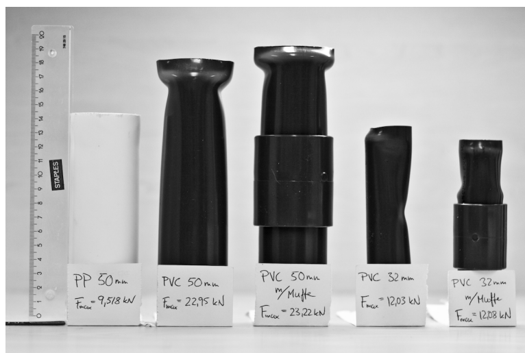
Figur 5.1: Deformerte rør etter stukingsforsøk
