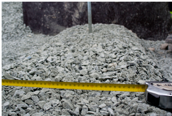
Figur 7.27: Bruddform oppløftsforsøk, H/D=2 , ukomprimert
