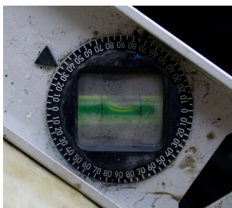
Figur 7.13: Måling av helning på bratt grøft i felt
