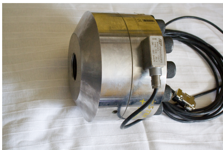
Figur 7.4: Lastcelle feltforsøk, 300 kN
