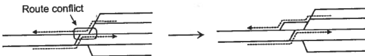
Figur 2: Eksempel på løsning av kryssende togveg 1 (Pachl, 2002)
