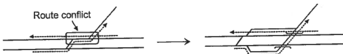
Figur 3: Eksempel på løsning for kryssende togveg 2 (Pachl, 2002)
