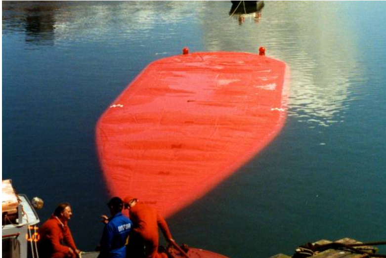
Bilde 16. Illustrasjon av Unibag (Markleen Oil Spill Technology).
