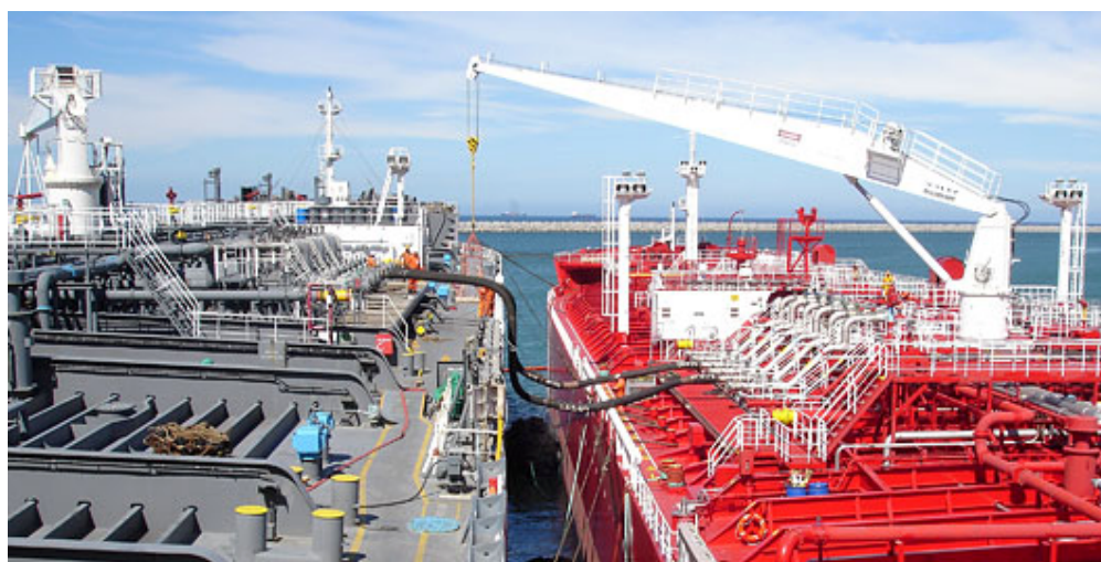
Bilde 3. Skipene er forsvarlig fortøyd, slangene er koblet til manifolde og Yokohama-fenderne ligger for å hindre sammenstøt mellom skipene (Gulf Agency Company, u.d.).
