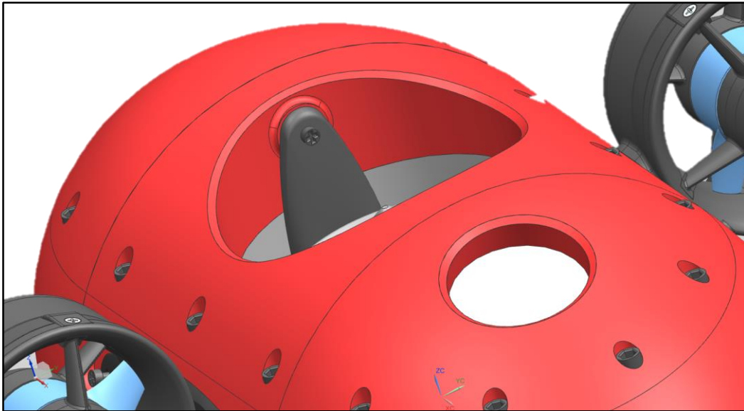
Figur 32. Dekselets innfestningsmetode sett bakfra.
