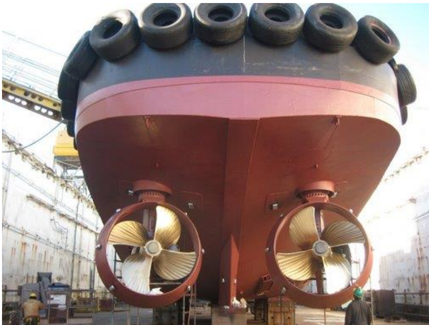
Figur 2.9.2: Et to-skruesystem med dyser på en slepebåt. Vi ser at propellene har ulik rotasjonsretning. [61]
