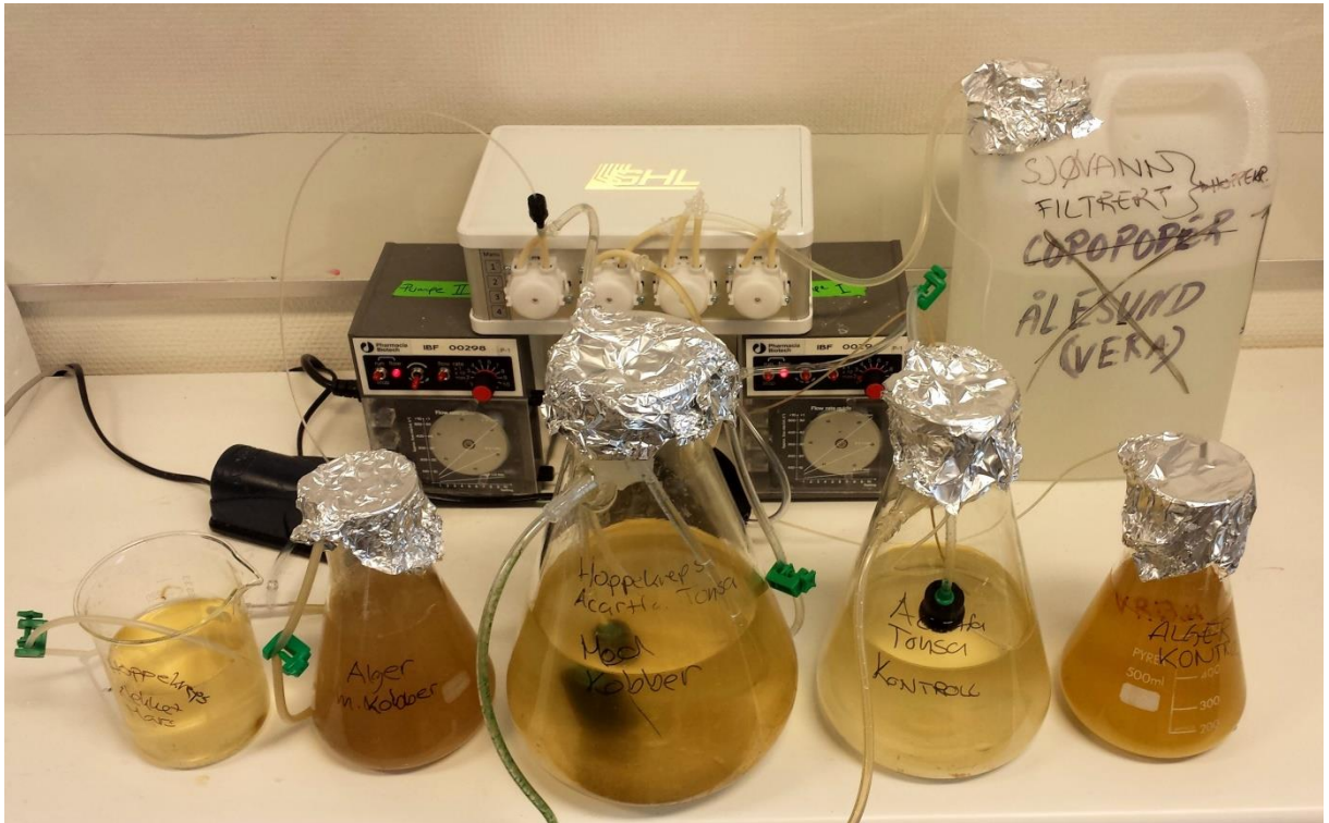
Figur 25 Oppsett til inkubering av hoppekreps og mikroplast med kobber.
