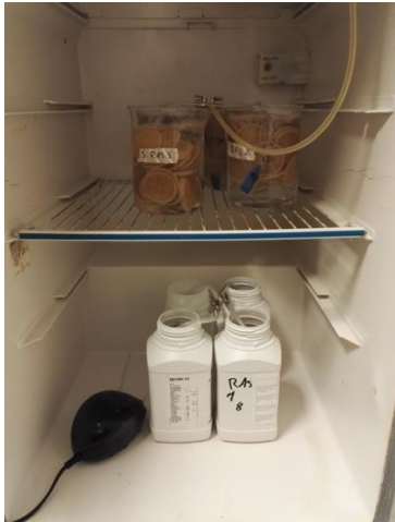
Figur 3: Kjøleskap for hovedforsøk med MBBR og vann fra anlegg
