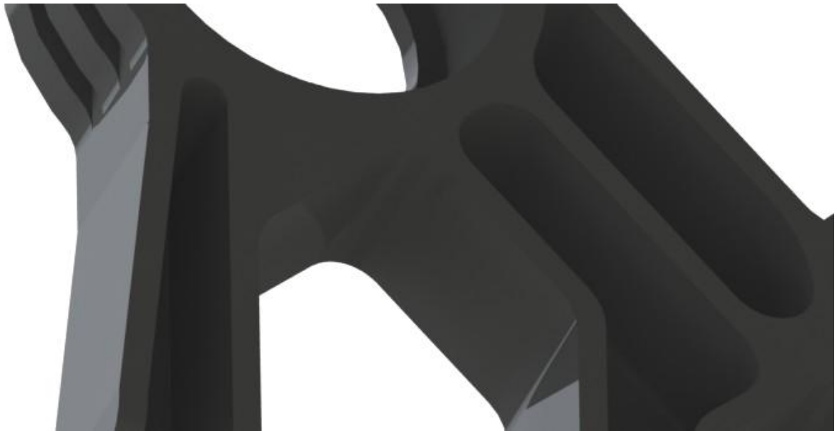
Figur 55: Hybrid løsning tilpasset til regel om minimum 45-graders helning
