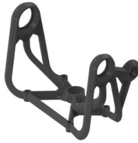
Figur 48: Modell av den additive løsningen ved slutten av steg 2
