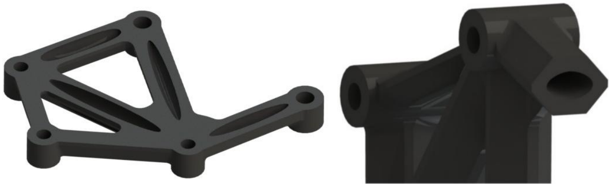
Figur 39: Indre kaviteter i HT-design
