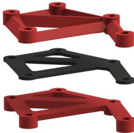
Figur 44: Alternativ brakett med fordeling mellom subtraktiv og additiv tilvirkning
