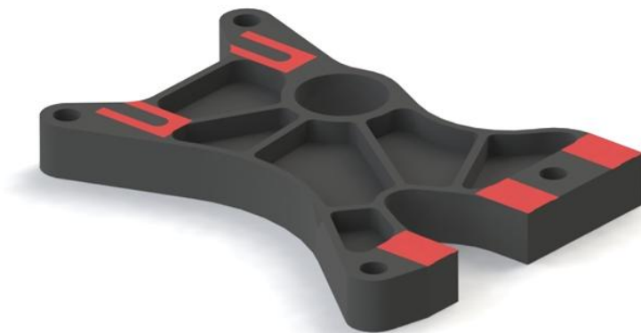
Figur 53: Bunnplate, subtraktiv av den hybride modellen
