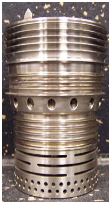
Bilde 11: Reparert component til gassturbin
