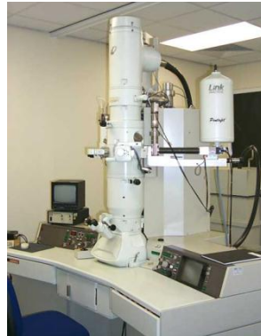
Figure 5.10: The JEOL JEM-2010 TEM [115]
