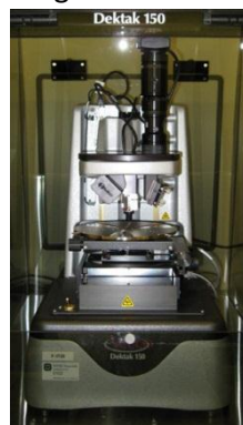
Figure 5.11: The Veeco Dektak 150 profilometer [116]
