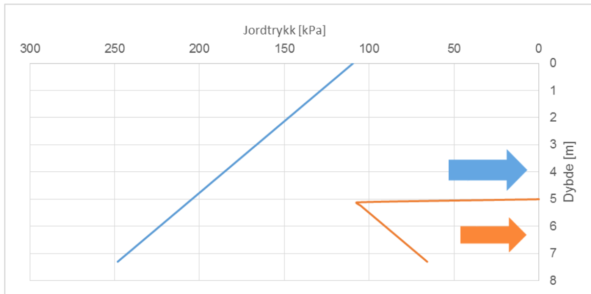
Figur 55 Jordtrykk på bakvegg ved pressing etter håndberegning udrenert konstant su
