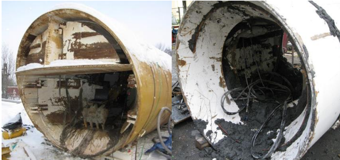
Figur 5 (a) Åpen front med graveutstyr. Porter kan stenges for å bedre stoffstabiliteten ved dårlige masser (b) Åpen front uten graveutstyr (Føyn og Lauritzen, 2014)
