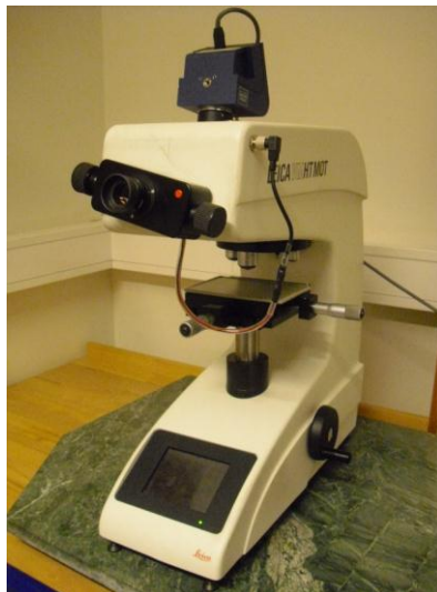
Figur 3.1: Mikrohardhetsmåler og prøve, med et mikroskop festet på apparatet for å kunne måle inntrykkets diagonaler.
